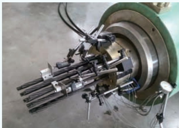
图4 拉索组装件静载张拉测试图
