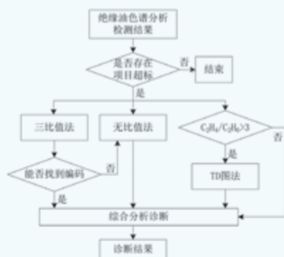
图4 绝缘油色谱综合故障诊断方法
