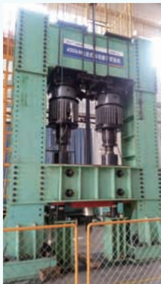
图5 拉索组装件疲劳试验测试图
