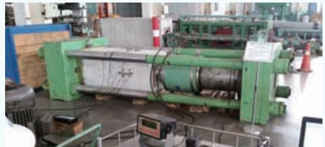
图7 荷载传递性能试验测试图
