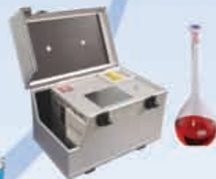
油液污染 颗粒检测仪
