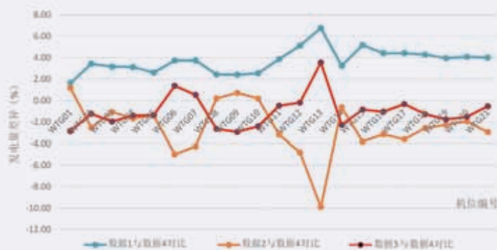
图6 数据1、数据2及数据3相对数据4的发电量变化
