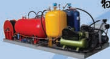
GRS系列风场齿轮箱换油装置
