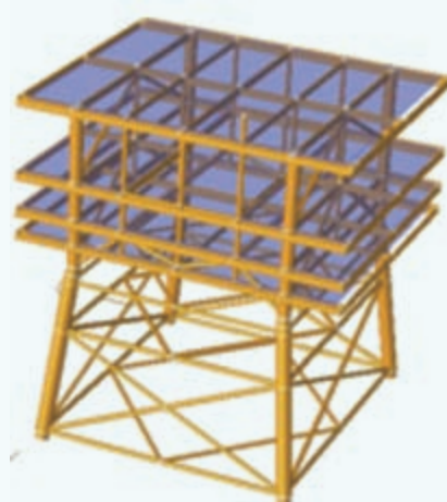
图1 海上升压站结构模型
