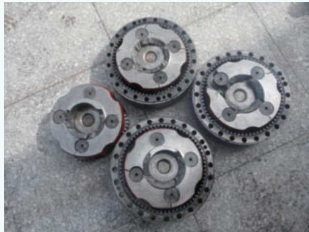
图11 某1.5MW机型偏航减速器行星架损坏的照片
