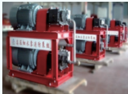
图3 高压细水雾灭火系统
