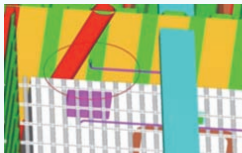
图2 穿舱件与斜撑干涉图
