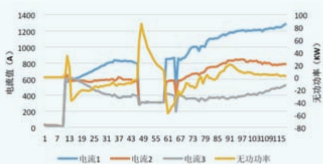
图9 三相电流曲线与无功功率关系曲线图
