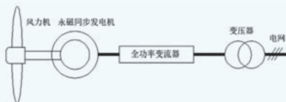
图1 直驱永磁风力发电系统
