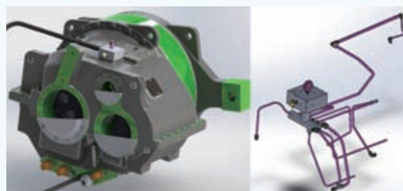
图4 左图，测试流量时装配情况示意图；右图，油管三维模型
