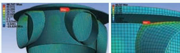
图9 疲劳载荷下限值对应的过渡段应力分布
